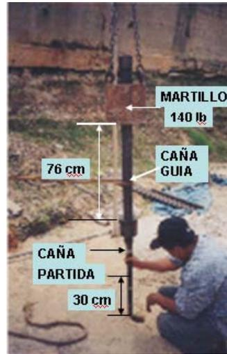
Elementos del ensayo de Penetración estándar.
