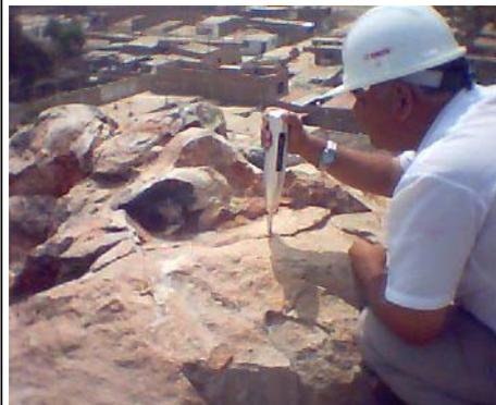
Detalle de la ejecución de ensayo de compresión, usando el esclerómetro.
